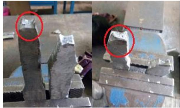
Gambar 6. Penampang las dengan media collant radiator
