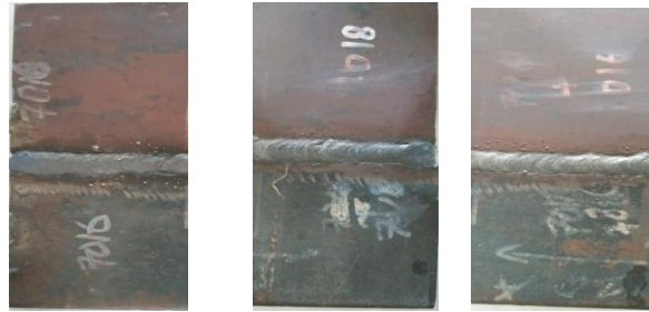
Gambar 3 Hasil pengelasan dengan Elektroda E7016, E7018, dan E7016+E7018
