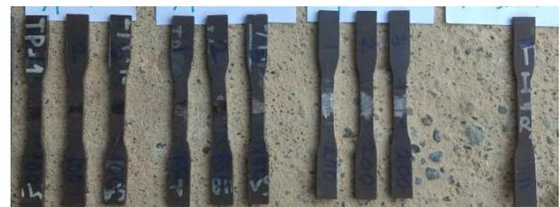
Gambar 5. Spesimen uji tarik
