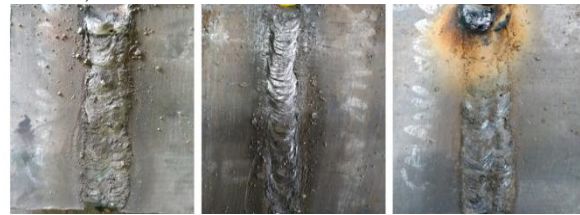
Gambar 4.1 Hasil pengelasan V Groove , Bevel Groove dan Double V Groove
