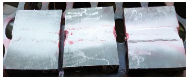
Gambar 4.2 Hasil Pengujian Penetrant
