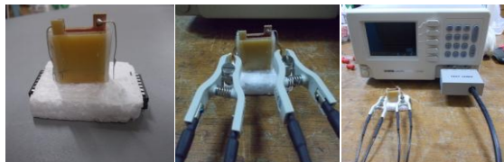
Gambar 4 Proses penentuan karakter dielektrik udara dengan LCR-Meter
