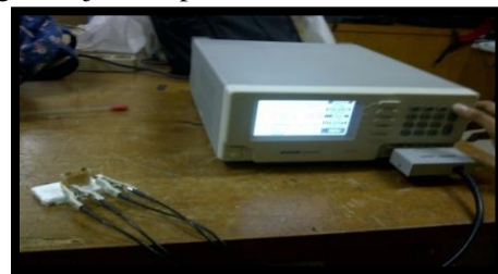
Gambar 3 Rangkaian sistem pengukuran LCR meter
