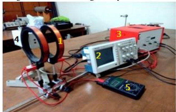
Gambar 5. ESR Leybold Heracus yang terdiri dari (1) kumparan Helmholtz, (2) osiloskop, (3) catu daya sebagai penyedia tegangan, (4) alat pengendali frekuensi ESR, dan (5) amperemeter.
