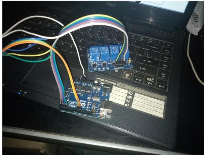
**Gambar 3. Rangkaian Arduino Dengan Reley Module**
