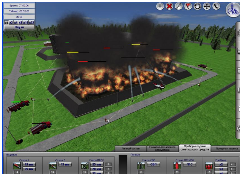
Рис. 4. Локалізація гасіння пожежі на комп'ютерному тренажері об'єкта зберігання нафти та нафтопродуктів
