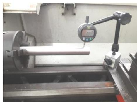
**Gambar 9.** Proses *set-up* benda kerja.
