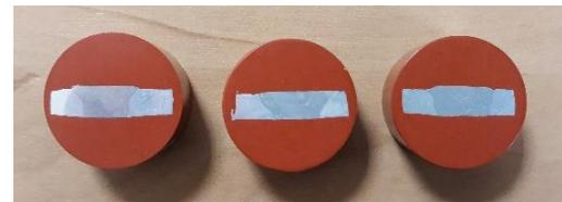
Gambar 8. Spesimen Uji Keras
