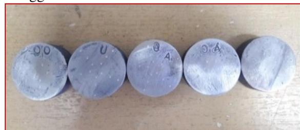
**Gambar 6.** Spesimen Hasil Pengujian Kekerasan Rockwell
