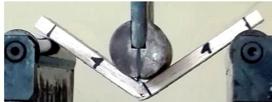
**Gambar 6.** kegagalan specimen pengujian bending bahan komposit sandwich kayu Sengon *polyester* serat gelas
