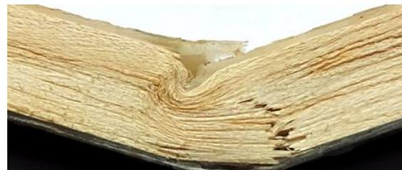
**Gambar 7.** Pola kegagalan specimen komposit sandwich kayu Sengon *polyester* serat gelas oleh pengujian bending. (foto camera digital 2:1)
