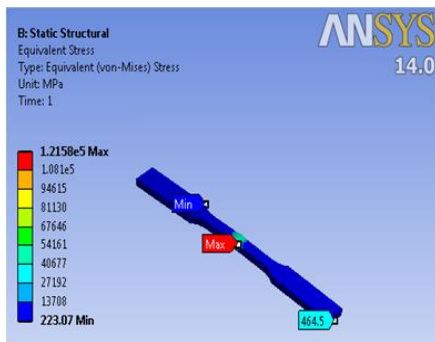
Gambar 12. Distribusi tegangan dengan beban 20000 N
