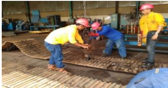
Gambar 14. Proses Penggantian Track Shoe Sebelum Menggunakan Tool
