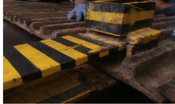
Gambar 11. Penjepitan Track Shoe dengan Menggunakan Holder Hydraulic Torque Wrench
