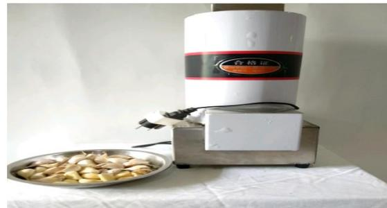
**Gambar 3.** Perancangan mesin Pengupas bawang
