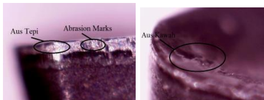
Gambar 17. Bentuk tumbuhnya lapisan metal (BUE) pada pemotongan V_c 250 m/menit
