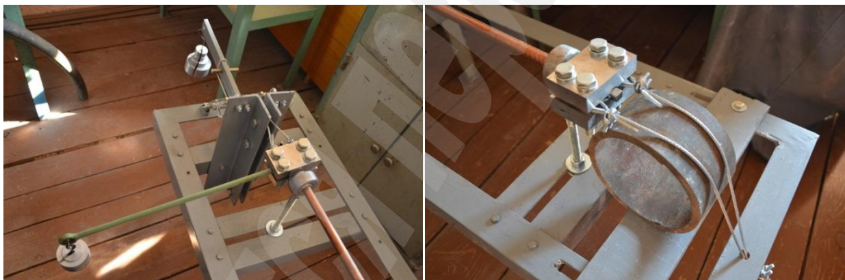
Рис. 3. Окремі вузли експериментального станду: а – навантажувальний вузол; б – опорний вузол
