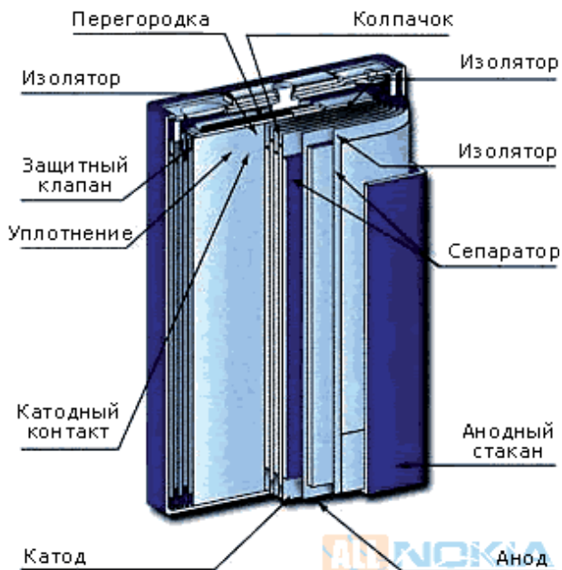
Рис. 2. Схема конструкції Li-Ion-акумулятора
