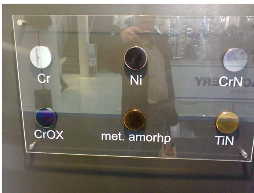
Рис. 1.6. Внешний вид типичных покрытий каналов течения расплава
