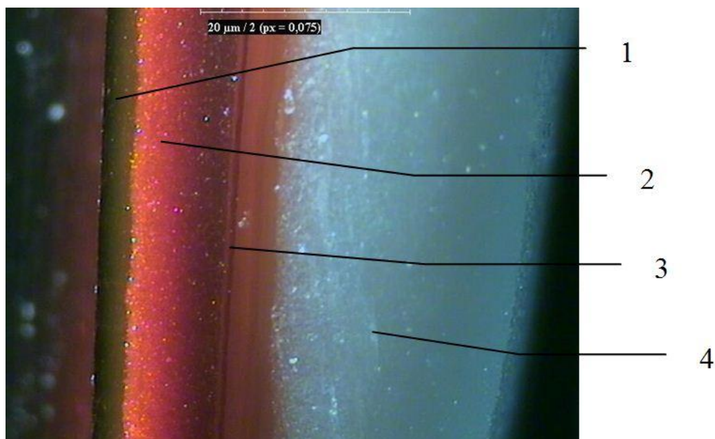
Рис. 3.12. Фотография среза пристенной области течения. Пристенная область (оттенки черного и темно коричневого цвета) состоит из трех областей: 1 – область контакта расплава с дюзой, пристенный слой, 2 – область низковязкого расплава, 3 – область расплава с нормальной вязкостью и цветом,
