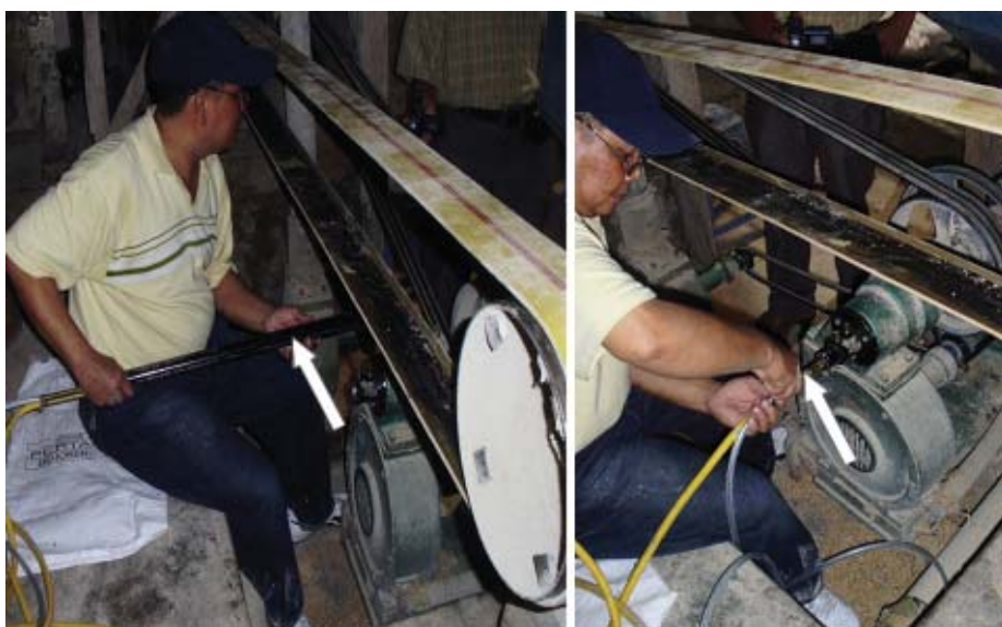
Gambar 2. Pemasangan alat pengabut air tipe bayonet (ditunjuk tanda panah) pada mesin penyosoh beras di Pariaman, Sumatera Barat.
