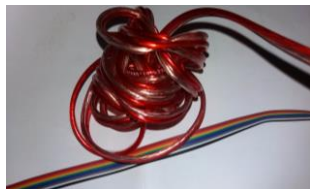
Gambar 2.15 Kabel Pelangi dan Kabel 2 Warna
