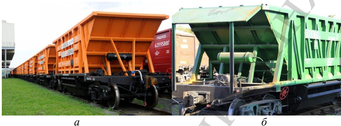
Рис. 1. Вагони-хопери для перевезення окатишів та гарячого агломерату: а – модель 20–5197; б – модель 20–9749
