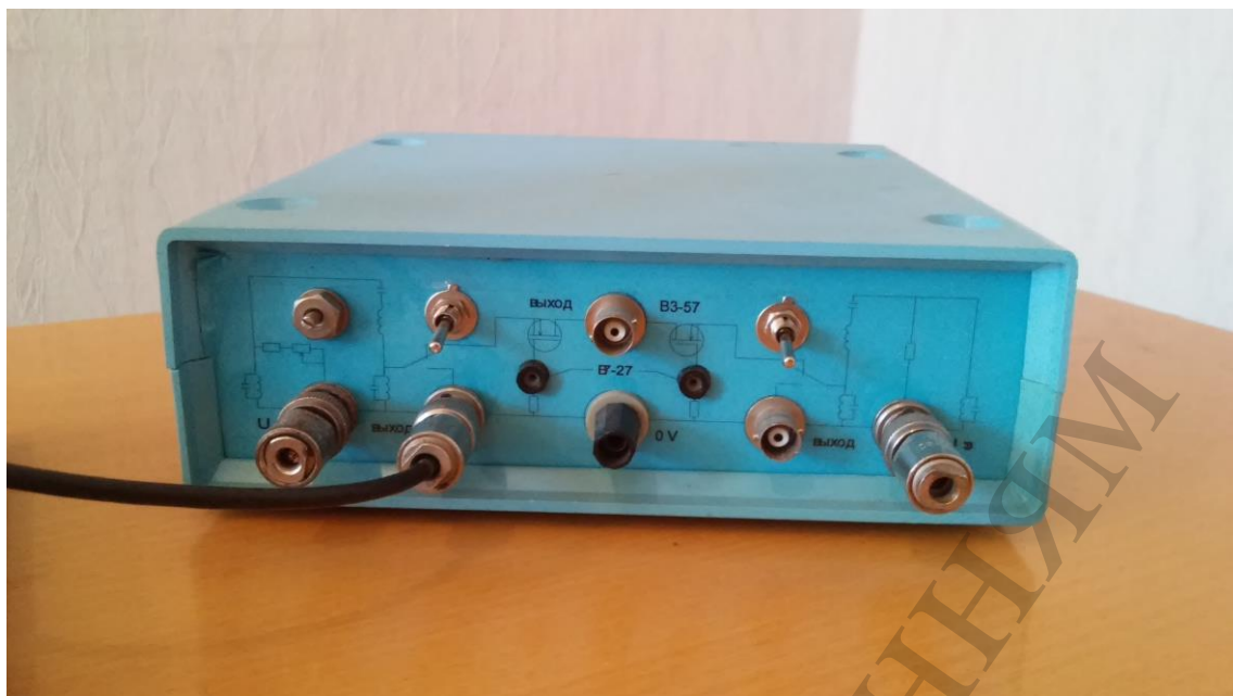
Рис. 3. Блок коммутации: а – электронный коммутатор с имитатором шума и эквивалентной схемой ФПП в структурной схеме макета АТ; б – внешний вид
