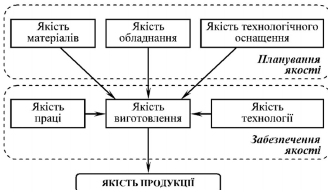
Рисунок 1.4 – Схема формування якості продукції у процесі виробництва
