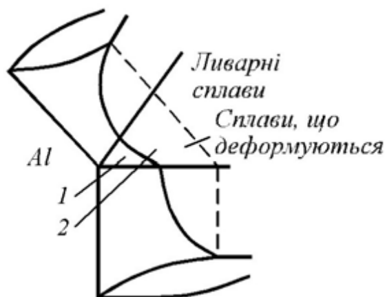
Рисунок 4.1 – Класифікація алюмінієвих сплавів за діаграмою станів: 1 – незмцнювані термічною обробкою; 2 – змцнювані термічною обробкою
