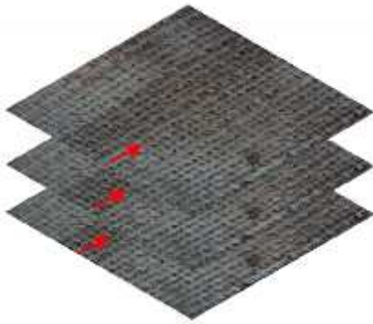
Gambar 1. Susunan Komposit Serat jute 3 lapis
