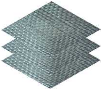
Gambar 2 Susunan Komposit Serat e-glass 3 lapis
