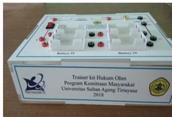
Gambar 5. Kit alat praktikum hukum Ohm yang siap digunakan untuk kegiatan praktikum.
