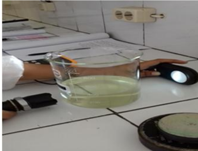
Gambar 1. Pengukuran intensitas cahaya pada gelas beker berisi air tanpa pengaruh medan magnet
