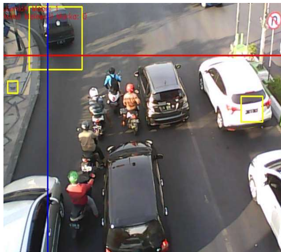
Gambar 5. Sistem mendeteksi 1 mobil tanpa pelanggar marka jalan dinyatakan TRUE
