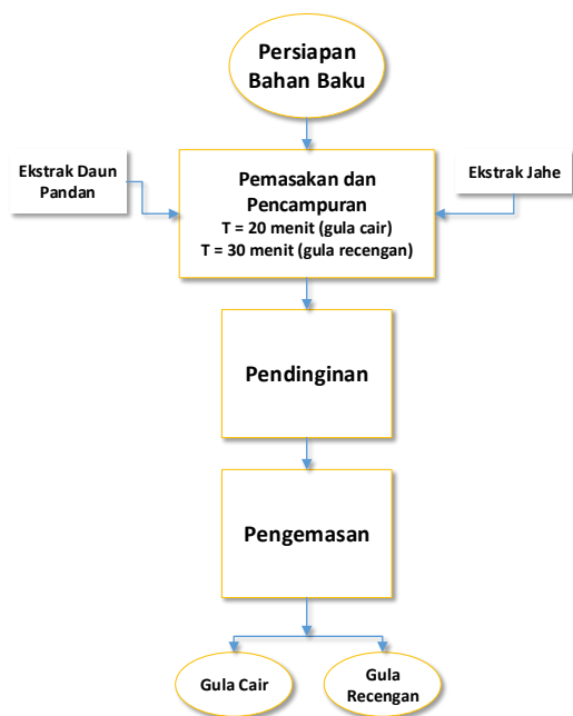
Gambar 1. Alur Pembuatan Gula Cair dan Gula Recengan
