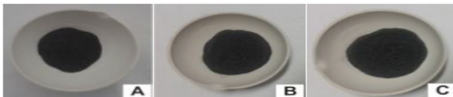
Gambar 3.1. Hasil Sintesis CNF dari Serabut Kelapa Pada Temperatur 600° C, 700° C, 800° C
