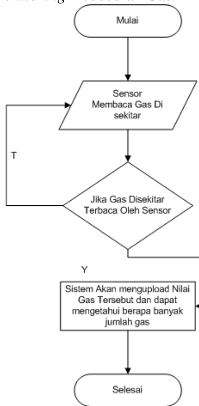
Gambar 4. Diagram Alur Perangkat Lunak Dengan Sensor MQ-2
