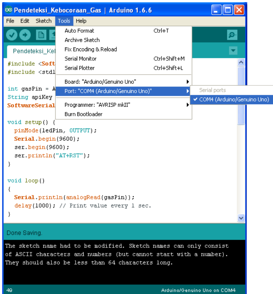
Gambar 8. Port COM4 Arduino Uno
