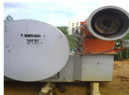
Gambar 2. *Burner Kerosin*
