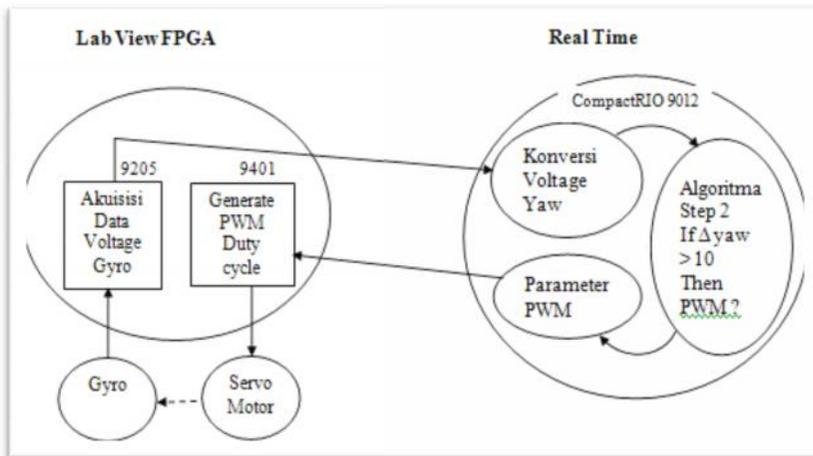
Gambar. 4(b). Diagram alir fungsi kerja AI 9205, 9012 Controller dan DO 9401
