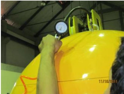
Gambar 10. Proses Pemberian tekanan udara pada subbuoy sebagai test kebocoran & agar air tidak merembes ke ruangan dalam subbuoy
