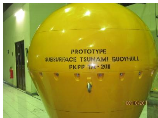
Gambar 9. Penandaan (marking) SubBuoy selesai untuk persiapan uji di Tanki
