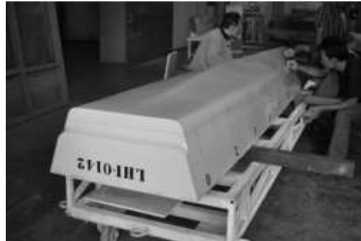
Gambar 9 Tahap pengecatan model uji kapal
