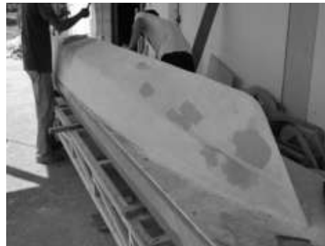
Gambar 2 Pendempulan lambung model uji
