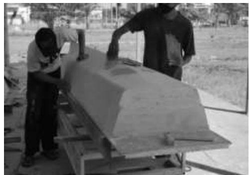
Gambar 5 Penghalusan body model uji
