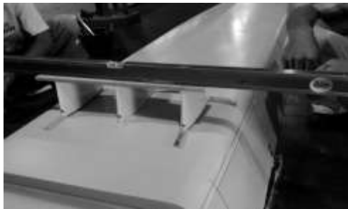
Gambar 13 Pengukuran jarak antar skeg
