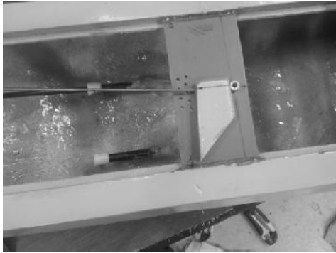
Gambar 5. Skeg yang telah dimodifikasi
