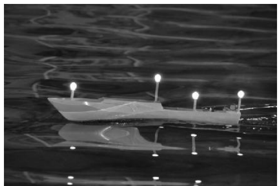
Gambar 12. Pengujian Seakeeping Arah Gelombang 135 deg, dengan sudut Skeg 0 deg
