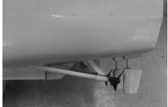
Gambar 8. Daun Kemudi ( rudder ) dan Propeller
