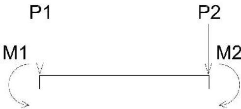
Gambar 1. Anggota struktur yang terkena beban p_x dan p_y dan momen m
