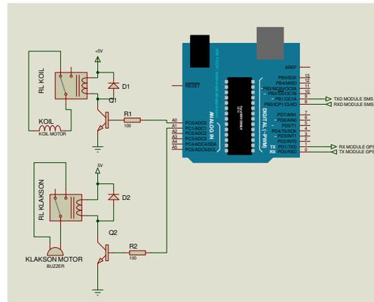
Gambar 5 Skematik sistem pengontrol kendaraan bermotor secara keseluruhan
