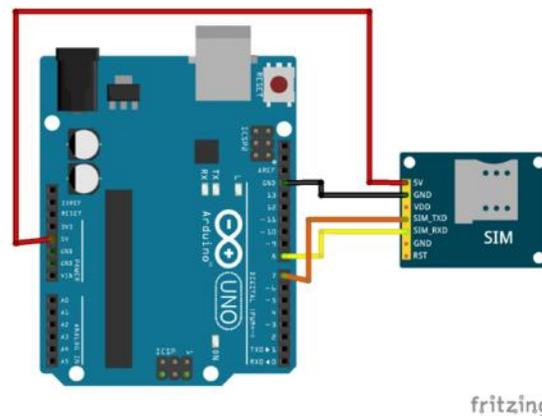
Gambar 6 Rangkaian skematik mikrokontroler dan GSM shield
