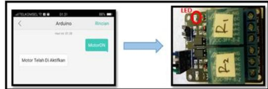
Gambar 13 Tampilan di Aplikasi SMS dan Kondisi Relay Coil Motor (R1) Pada Saat diberi Perintah "MotorON"
