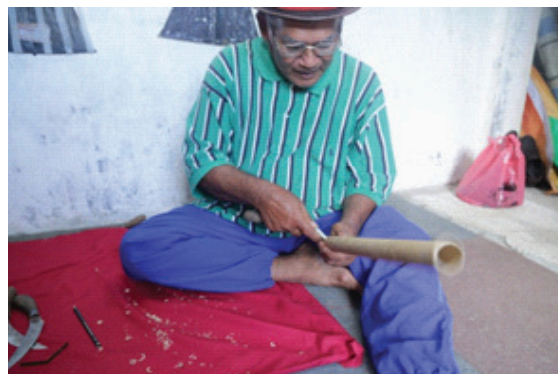
Gambar 12. Pembuatan lobang nada sementara (Foto: Ediwar, dkk., 2018)
