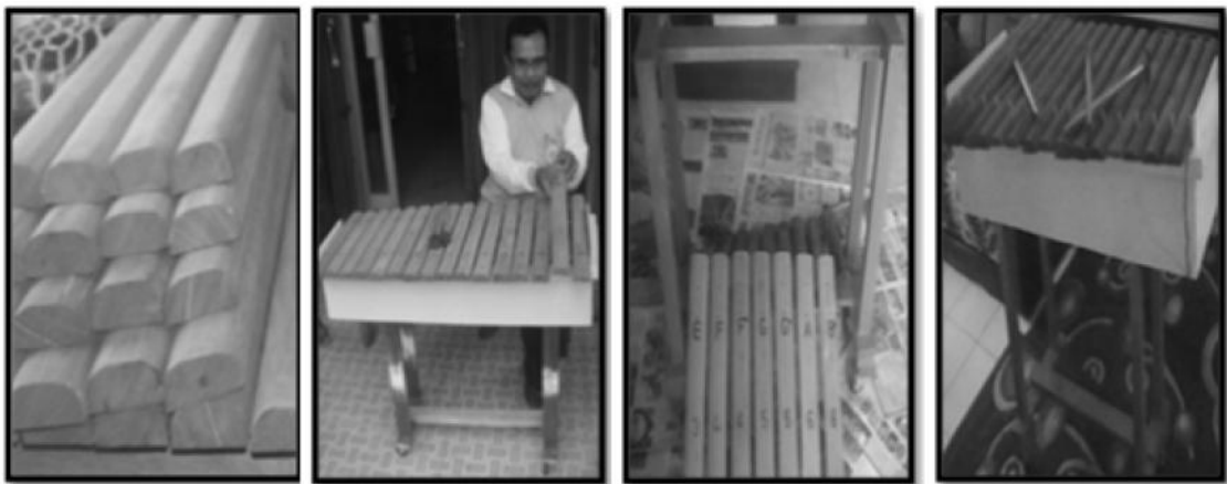
Gambar 5. Tahapan Pembuatan Kolintang Pengiring untuk Prototype Abakod (2013)
