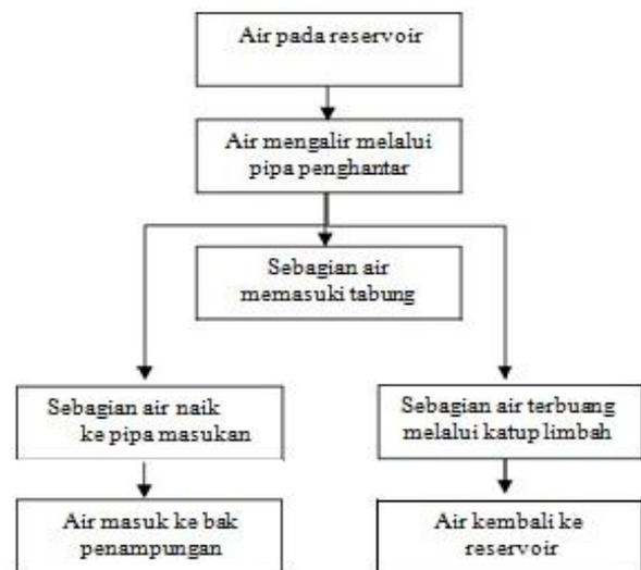
Gambar 1. Skema Prinsip Kerja Pompa Hidram
