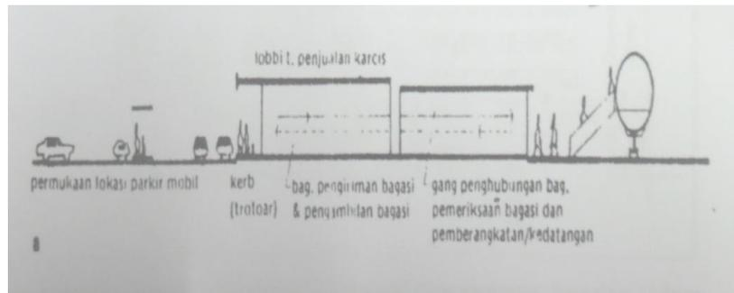
Gambar 2. Sistem Pemrosesan Penumpang Bandar Udara
