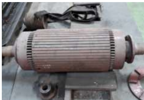
■ Gambar 4. Kondisi Rotor sebelum overhaul .
