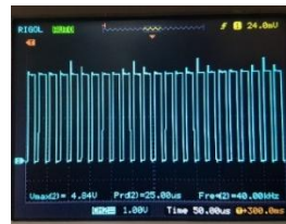
■ Gambar 5. Sinyal Ultrasonik 40kHz yang Dibangkitkan NE555 Mode Astable
