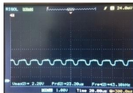
■ Gambar 6. Sinyal Ultrasonik yang Diterima Transduser Penerima dan Telah Diperkuat Dua Kali
