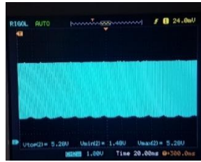
■ Gambar 8. Sinyal Ultrasonik yang Diterima Transduser Penerima Setelah Melewati Kayu Tanpa Cacat Sesudah Diperkuat Empat Kali
