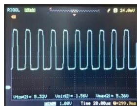
■ Gambar 7. Sinyal Ultrasonik yang Diterima Transduser Penerima dan Telah Diperkuat Empat Kali
