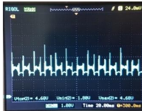
■ Gambar 9. Sinyal Ultrasonik yang Diterima Transduser Penerima Setelah Melewati Kayu Dengan Cacat Sesudah Diperkuat Empat Kali
