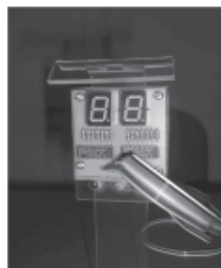
Gambar 17. Rangkaian LED dan rangkaian 7-segmet
