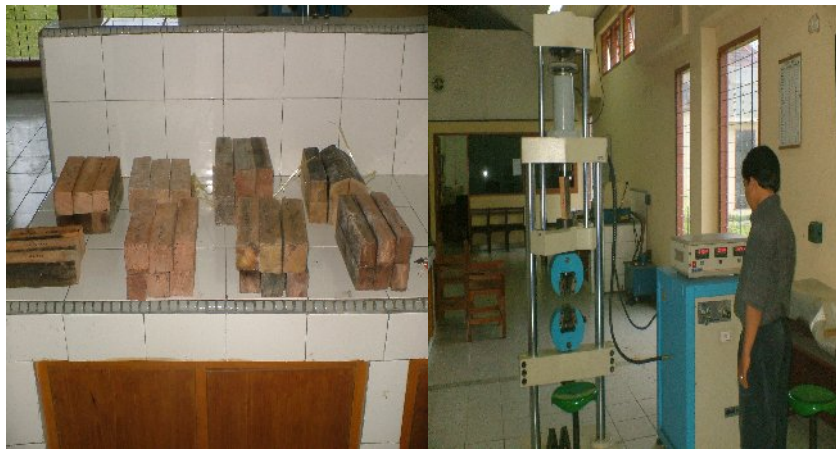
Gambar 1. Sampel kayu (kiri) yang diuji kekuatan tekannya (kanan) .
