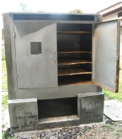
Gambar 2. Instrumen Dehidrator: a) Tampak Belakang, belum berpintu; dan b) Tampak Depan, memperlihatkan pintu yang terbuka dan rak-rak yang sudah terpasang.
