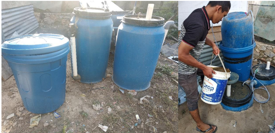
Gambar 2. Kelengkapan Instalasi Biogas Mini.
