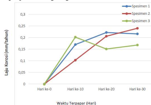
Gambar 6 Grafik Laju Korosi Pada Larutan 6% NH 4 Cl
