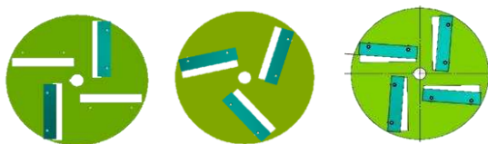
Gambar 6. Posisi pemasangan pisau
